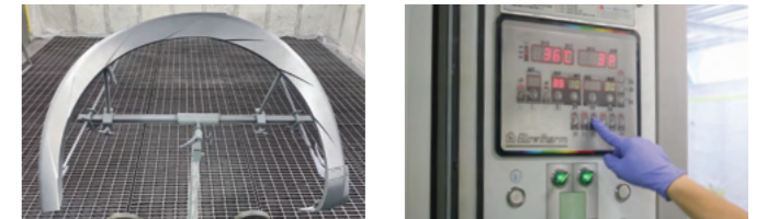
4. EZ240(희석제) 제품을 혼합한 도료를 웨트-온-드라이 방식으로 얇게 3회 도장 후 충분히 건조 베이스코트를 아주 얇게 뿌리는 것이 매우 중요함 *도장 방법: 거리 35cm 내외 / 압력 1.8bar / 속도 100cm/s / 겹침폭 3/4
